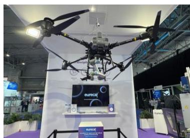
El centro tecnológico Eurecat ha avanzado en la feria Advanced Factories un robot aéreo autónomo con una alta capacidad de carga de hasta 35 kg, que permite nuevas operaciones de automatización en logística, así como nuevos enfoques en mantenimiento y construcción, ya que integra un brazo robótico para manipulación aérea precisa.
