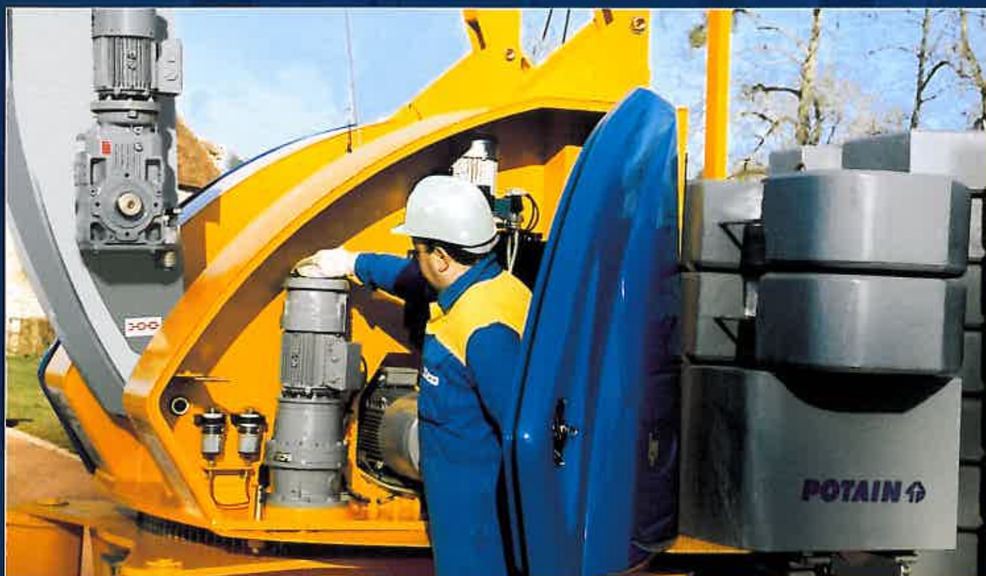
Acceso a la central hidráulica y mando de la puesta en veleta
