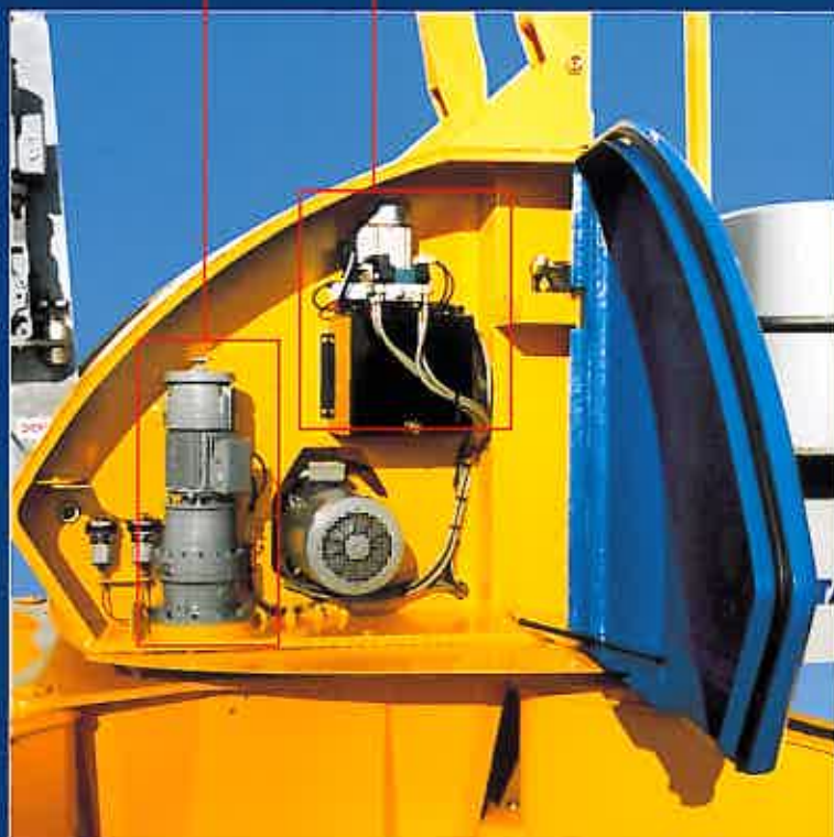
Central hidráulica equipada con electroválvulas
