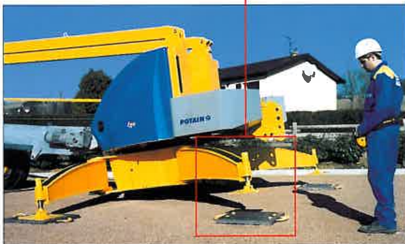
Operación de calce
