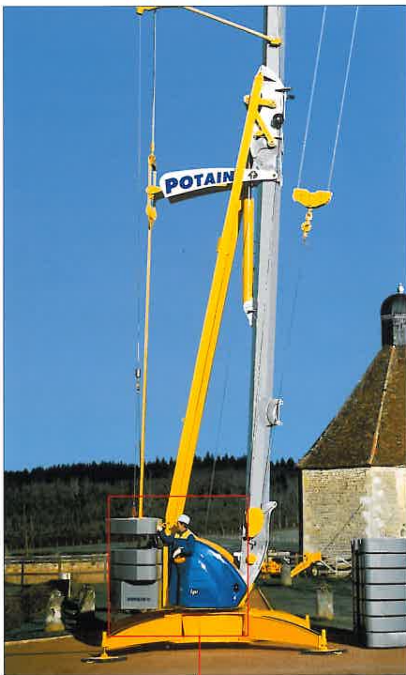
Sistema de autolastrado
