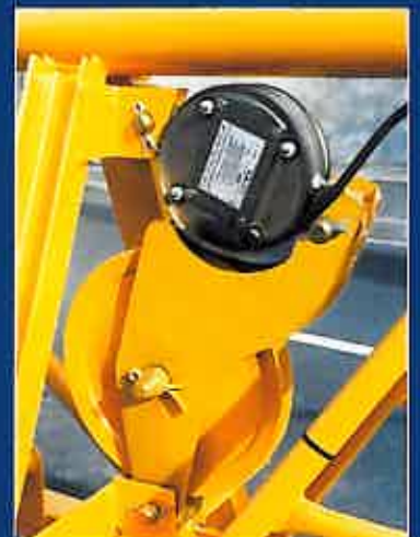
Seguridad de carga por anillo dinamométrico
