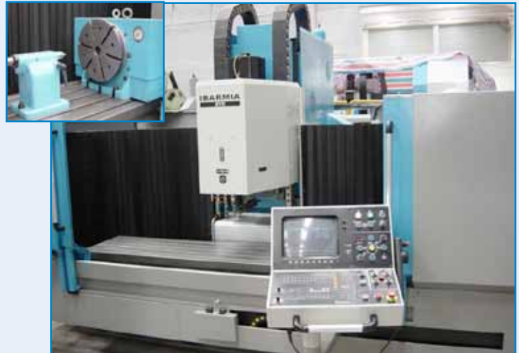
075/P011 IBARMIA ZVX 2000 . CNC HEIDENHAIN TNC 407. 6500 rpm. Recorridos: 2200x500x500 mm • 4º eje plato divisor Ø315 m. Retrofitada'13 075/P011 IBARMIA ZVX 2000 . CNC HEIDENHAIN TNC 407. 6500 rpm. Travels: 2200x500x500 mm. • 4º axis divisor plate Ø315 mm. Retrofitted'13
