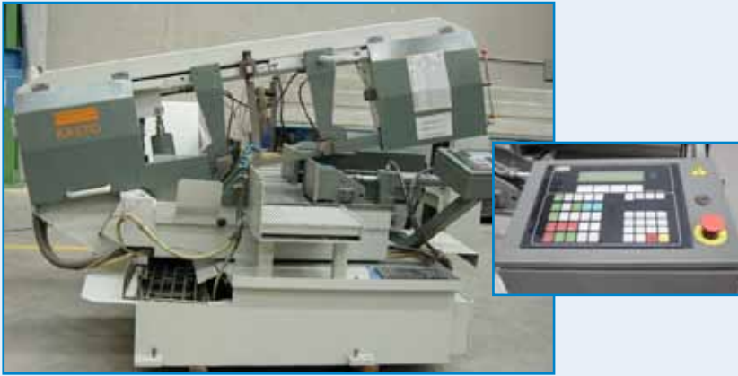
170/M119 KASTO SBA 320AU-NC . Automática. Corte Ø320 mm. • Longitud alimentador 600 mm hasta 5400 mm. 170/M119 KASTO SBA 320AU-NC . Automatic. Cutting Ø320 mm. • Feed length 600 mm to 5400 mm.
