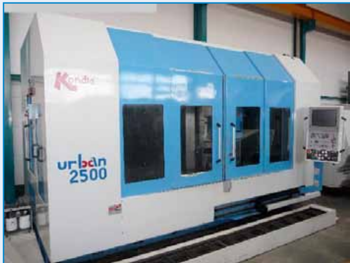
075/P033 KONDIA URBAN 2500 . CNC HEIDENHAIN TNC 426. 8000 rpm. Recorridos: 2500x500x610 mm. • Palpador infrarojo. 8700 horas de trabajo 075/P033 KONDIA URBAN 2500 . CNC HEIDENHAIN TNC 426. 8000 rpm Travels: 2500x500x610 mm. • Infrared touch probe. 8700 working hours
