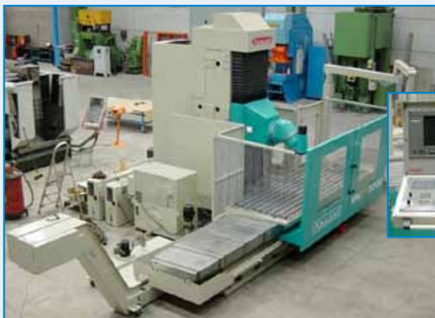
073/P044 Fresadora ANAYAK VHPLUS-3000 N CNC HEIDENHAIN TNC 426. Mesa 3200x1100 mm. Recorridos: 3000x1070x1500 mm. • Refrigeración interna. • Cabezal indexación automática A + B 1° y 2.5 ° • Extractor de virutas.
