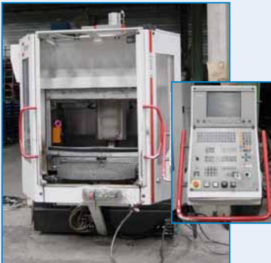
075/P042 HERMLE C-800 P con mesa pivotante PEISELER. 15000 rpm. CNC HEIDENHAIN TNC 430. Recorridos: 800x500x500 mm. • Refrigeración interna • Cargador de 30 uds • Extractor de virutas. 075/P042 HERMLE C-800 P with pivot pallet PEISELER. 15000 rpm CNC HEIDENHAIN TNC 430. Travels: 800x500x500 mm. • Internal cooling • Tool changer 30 uds. • Chip conveyor.
