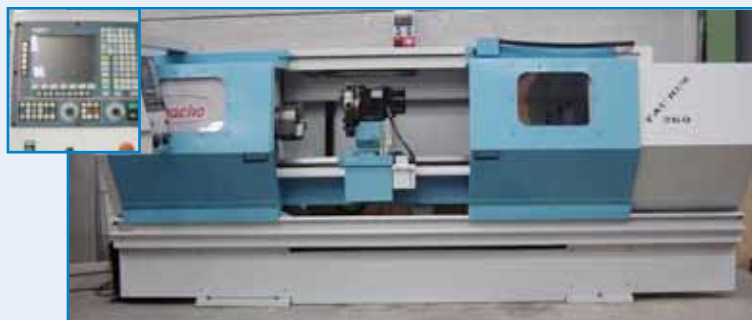
218/P036 Torno PINACHO TAURUS 260 CNC FAGOR 8055.E.P. 2000x Ø530mm. • Plato hidráulico Ø250mm • Torreta BARUFFALDI 8 posiciones. 218/P036 Lathe PINACHO TAURUS 260 CNC FAGOR 8055.E.P. 2000x Ø530mm. • Hydraulic chuck of Ø250mm • BARUFFALDI turret 8 positions.
