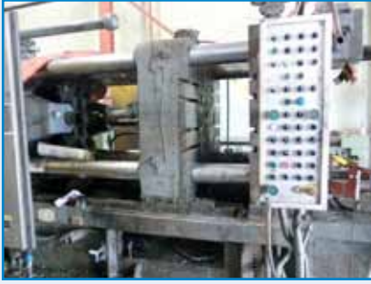
Inyectora cámara fría L.K. MACHINERY DCC630E . 630 Tn L.K. MACHINERY DCC630E . Cold chamber die casting machine. 630 Tn
