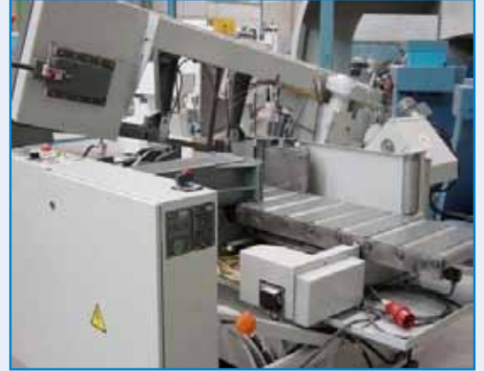
170/M119 KASTO SBA 320AU-NC . Automática. Corte Ø320 mm. • Longitud alimentador 600 mm hasta 5400 mm. 170/M119 KASTO SBA 320AU-NC . Automatic. Cutting Ø320 mm. • Feed length 600 mm to 5400 mm.
