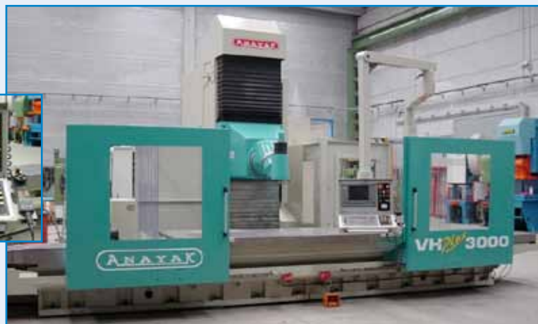
073/P044 Fresadora ANAYAK VHPLUS-3000 N CNC HEIDENHAIN TNC 426. Mesa 3200x1100 mm. Recorridos: 3000x1070x1500 mm. • Refrigeración interna. • Cabezal indexación automática A + B 1° y 2.5 ° • Extractor de virutas.
