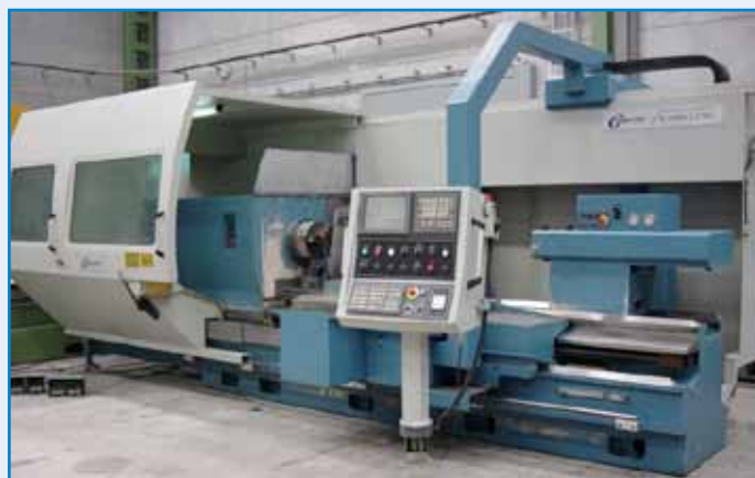
218/M066 Torno GURUTZE A1000/3G CNC FANUC 21 iTB. 4 guías. E.P. 2000x Ø870mm. Sólo 1400 horas de trabajo. • Plato hidráulico Ø 315 mm. • Extractor de virutas. • Contrapunto motorizado • Salida de caña hidráulica. • Doble puerta delantera. 218/M066 Lathe GURUTZE A1000/3G CNC FANUC 21 iTB. 4 guides. E.P. 2000x Ø870mm. Only 1400 working hours. • Hydraulic chuck Ø 315 mm. • Chip conveyor. • Cross-slide motorized • Hydraulic cane output. • Double front door.
