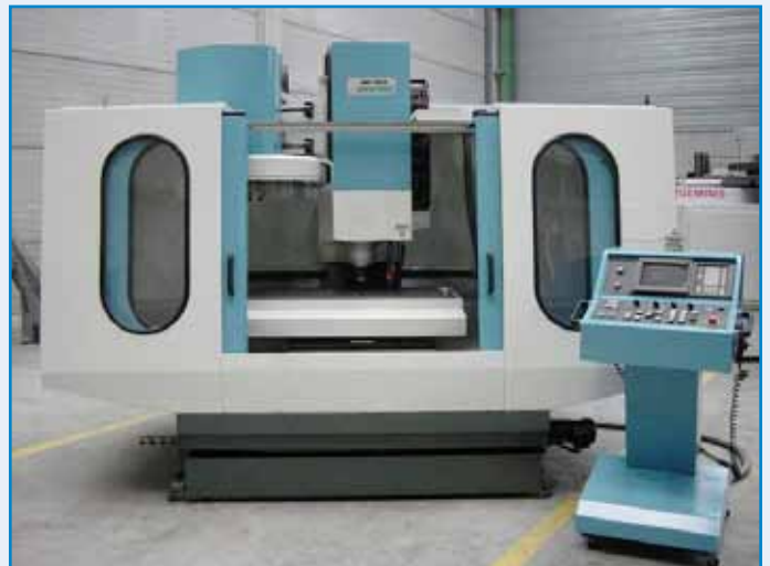
075/P035 JOHNFORD VMC 1024 . CNC FANUC O M - C. 6000 rpm. Recorridos: 1016x500x 570 mm. • Cargador de 24 uds 075/P035 JOHNFORD VMC 1024 . CNC FANUC O M - C. 6000 r.p.m. Travels: 1016x500x570 mm. • Tool changer 24 uds.
