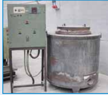
Horno LLOYD Aluminio. 250 Kgs. LLOYD Furnace 250 kgs.
