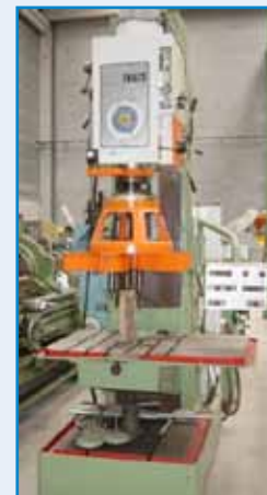
191/0029 IBA TMA-75 Ø75mm. • cabezal múltiple MIKRON 6 brazos 191/0029 IBA TMA-75 Ø75mm. • multiple head MIKRON 6 Arms
