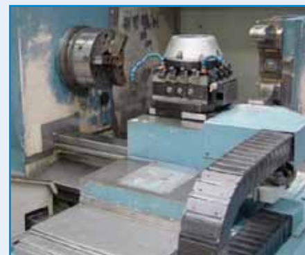
218/M066 Torno GURUTZE A1000/3G CNC FANUC 21 iTB. 4 guías. E.P. 2000x Ø870mm. Sólo 1400 horas de trabajo. • Plato hidráulico Ø 315 mm. • Extractor de virutas. • Contrapunto motorizado • Salida de caña hidráulica. • Doble puerta delantera. 218/M066 Lathe GURUTZE A1000/3G CNC FANUC 21 iTB. 4 guides. E.P. 2000x Ø870mm. Only 1400 working hours. • Hydraulic chuck Ø 315 mm. • Chip conveyor. • Cross-slide motorized • Hydraulic cane output. • Double front door.
