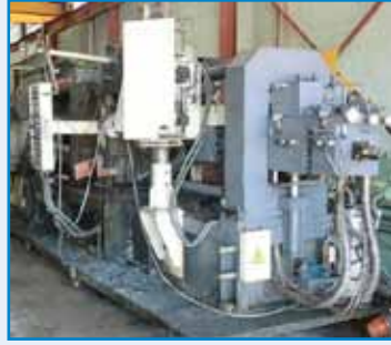
Inyectora cámara fría L.K. MACHINERY DCC630E . 630 Tn L.K. MACHINERY DCC630E . Cold chamber die casting machine. 630 Tn
