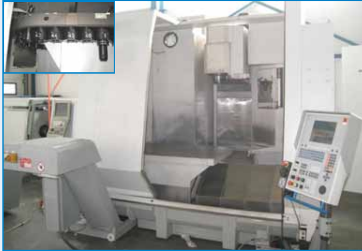
075/Q101 MIKRON VCP 1350 CNC HEIDENHAIN TNC 426M. 12000 rpm. Recorridos: 1350x820x600 mm. • 46 herramientas • Extractor de virutas. 075/Q101 MIKRON VCP 1350 CNC HEIDENHAIN TNC 426M. 12000 rpm. Travels: 1350x820x600 mm. • Tool changer 46 uds. • Chip conveyor.
