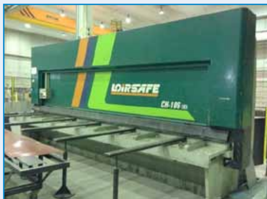
031/P010 LOIRESAFE CH106 CE . 6050 x 10 mm. • Posicionador ELGO. Año 2001. 031/P010 LOIRESAFE CH106 CE . 6050 x 10 mm. • ELGO positioner. Year 2001.
