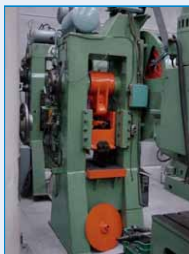
141/BA167 RIBA doble montante 100 Tn. Mesa 700x400 mm.
