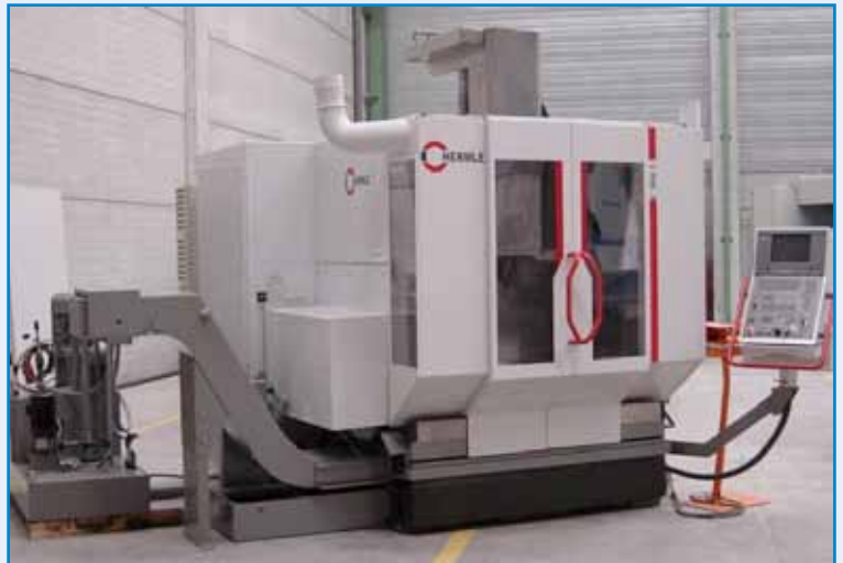
075/P043 HERMLE C-800 U 4 ejes continuos . CNC HEIDENHAIN TNC430 15000 rpm. Recorridos: 800x600x500 mm. • Refrigeración interna • Cargador de 30 uds • Extractor de virutas. Retrofitada. 075/P043 HERMLE C-800 U 4 axis continuous CNC HEIDENHAIN TNC430 15000 rpm. Travels: 800x600x500 mm. • Internal cooling • Tool changer with 30 uds. • Chip conveyor. Retrofitted.
