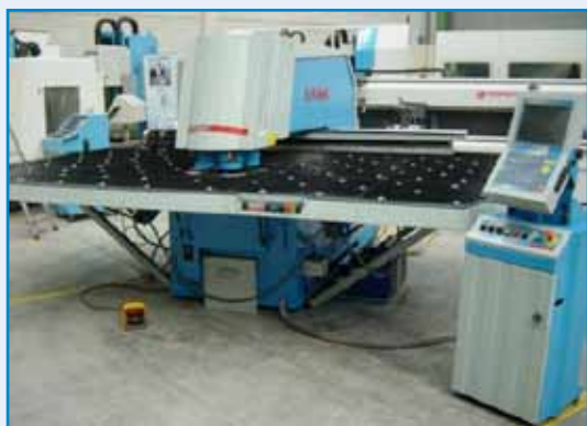
240/P037 EUROMAC MTX 1250/30 2000 CNC . 5 Estaciones (2 Índex) Mesa 2200x2260 mm. Potencia 300 kN. Capacidad para 6 útiles. 240/P037 EUROMAC MTX 1250/30 2000 CNC . 5 Stations (2 Index) Table 2200x2260 mm. Power 300 kN. Capacity for 6 tools.
