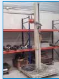
Polipasto 250kg. Bandera 2,2x3m Half bridge hoist. 250kg. 2,2x3m
