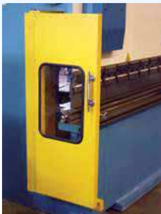
Protecciones laterales de policarbonato con micro de seguridad con sistema de enclavamiento cumpliendo la normativa CE.
