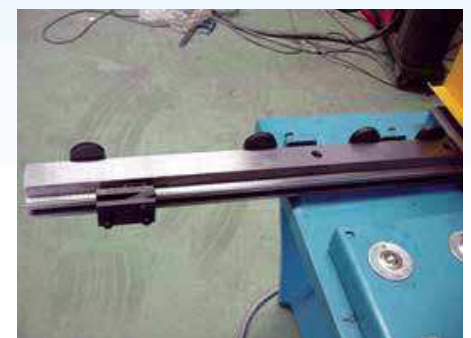
Barra escuadradora milimetrada y equipada con tope frontal abatible
