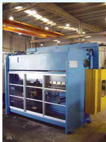
Vista trasera de la plegadora con protecciones de policarbonato y puerta corredera.
