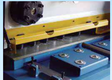
Protección frontal abatible, facilitando la mejor visualización en el corte.
