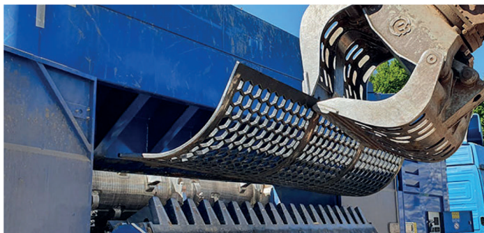
Definición del grano final mediante cestas tamizadoras y ranura de corte
