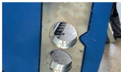
Espacio de corte ajustable para el tamaño de grano final (también Z 50)
