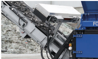
Imán ajustable hidráulicamente (también F 38)
