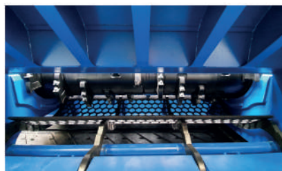
Resistente a enredos gracias a su rotor bidireccional (también Z 50)
