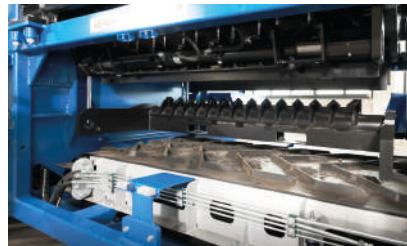
Barras rompedoras reemplazables en 10 minutos (también F 38)
