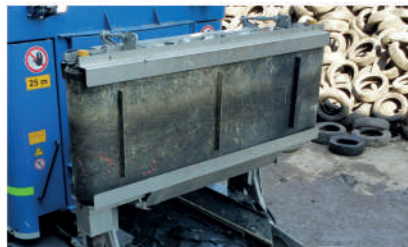
Potente imán de neodimio con descarga por ambos lados (también Z 60)
