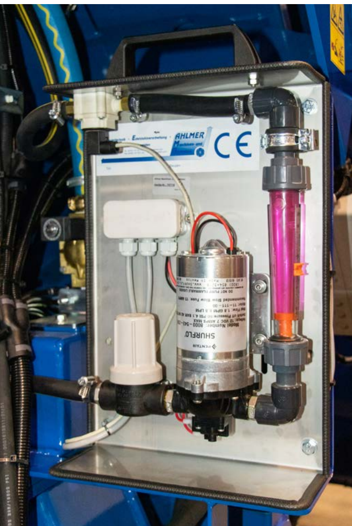
Bomba con filtro, mirilla y caudalímetro electrónico
