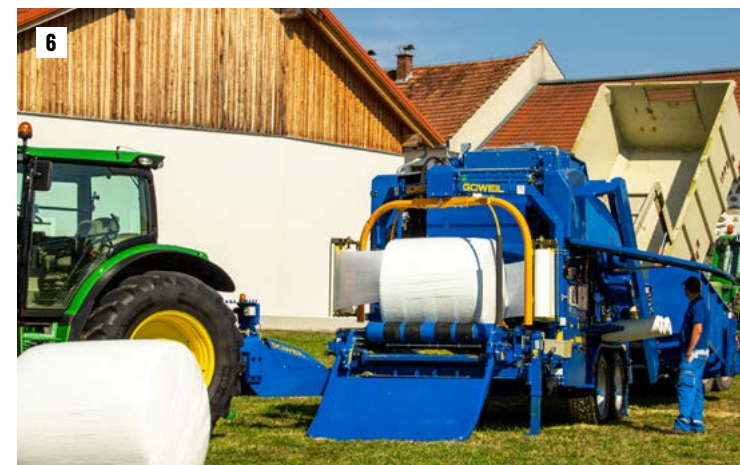
La paca es envuelta perfectamente y depositada después
