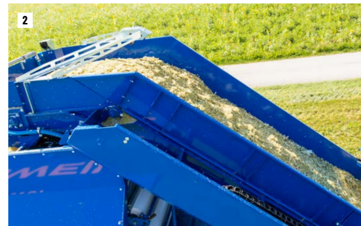
Perfectamente dosificado, el material pasa del alimentador al transportador escarpado
