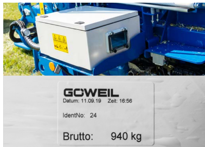
Impresora de etiquetas (arriba) y etiqueta adhesiva en la paca redonda (abajo)
