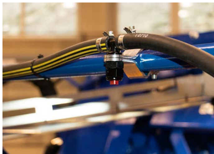
Dos boquillas de 0,1 en acero inoxidable
