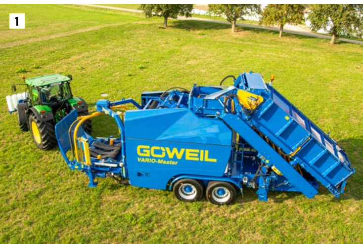
Posicionamiento correcto de la VARIO-Master y giro hacia fuera de la lanza
