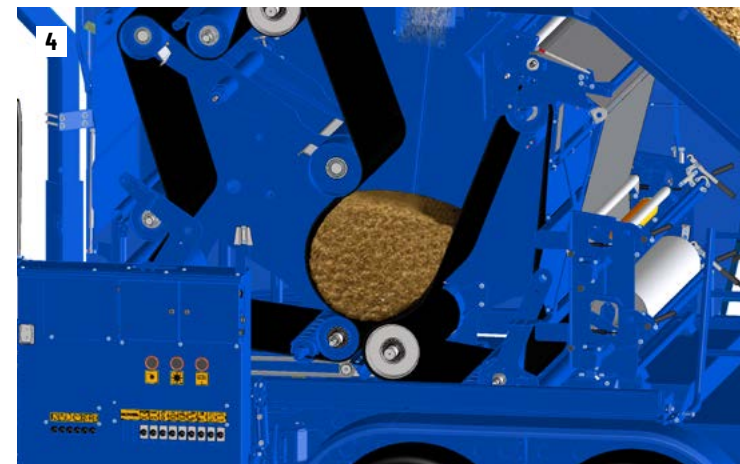
En la prensa, la paca es compactada fuertemente
