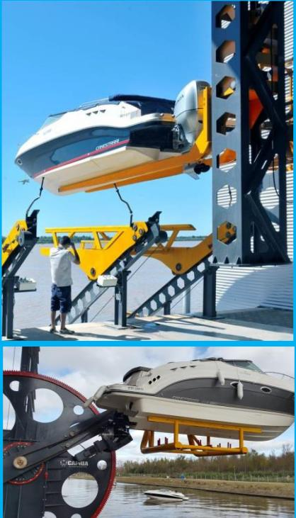
Equipamiento rápido y silencioso para almacenar en seco embarcaciones de hasta 15 toneladas.
