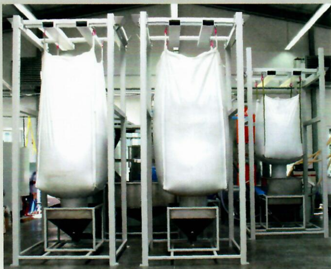
planta de mezclado de multicomponentes reprocesado propio / fragmentos de botella / PET reciclado (de izda. a drcha.)
