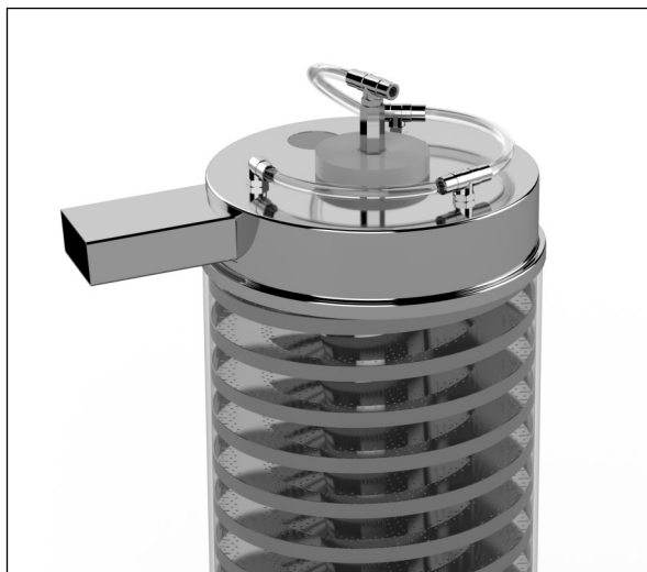
Flujo Radial de aire comprimido
