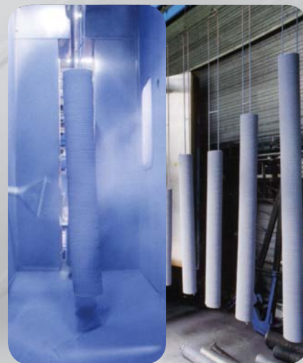
Instalación "bombardeo" de partículas y pintado en polvo.
