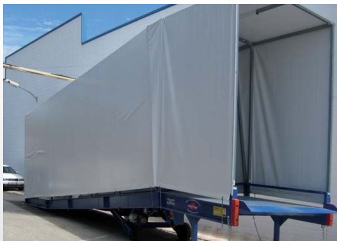
Rampa móvil con cubierta de PVC.
