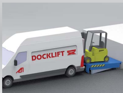
Docklift con labio partido para furgonetas.
