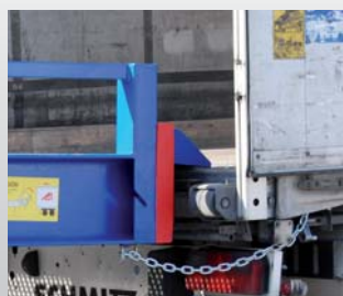
Tope de carga y cadena de enganche.
