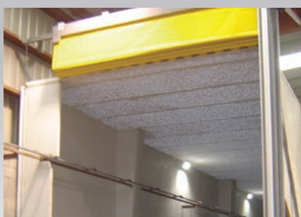
Puerta rápida en cabina.
