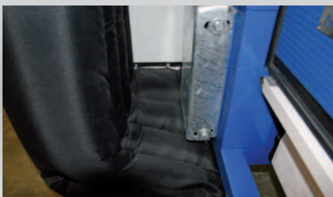
Detalle de estanqueidad en partes inferiores.
