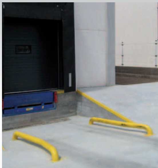
Guías G-25 de acero pintadas amarillo para empotrar.
