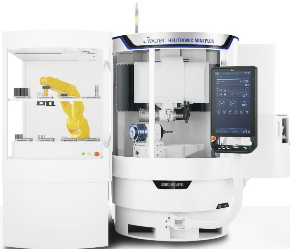
HELITRONIC MINI PLUS mit den Optionen Scheibenwechsler (rechts) und Robotlader (links)
