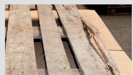
Traviesas rotas, tabla parcial o completamente rota
