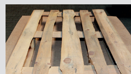
Componente inaceptable que no cumple con los Reglamentos Técnicos EPAL, p. Ej. dimensiones incorrectas, podredumbre, gema
