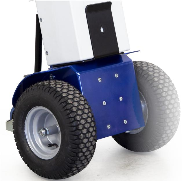
M12 está equipado de serie con **ruedas neumáticas**, aptas tanto para uso interior como exterior, para garantizar siempre la máxima adherencia al suelo y un nivel muy bajo de vibraciones. Además, son muy duraderas y ofrecen un rendimiento excepcional en cualquier terreno. Bajo pedido es posible montar otros tipos de neumáticos, como las **ruedas macizas "superelásticas que no dejan huellas"**, para suelos delicados.
