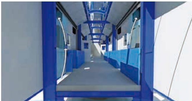
Pasillo central con reparto de ventilación a las salas.
