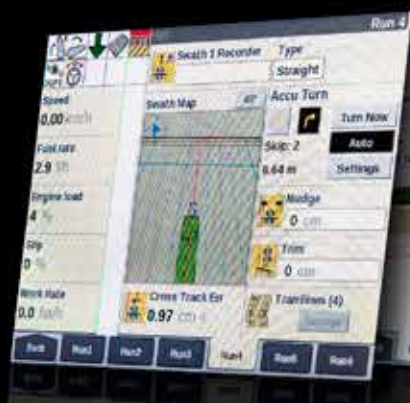
S-Turn II gira automáticamente al final de la línea de referencia
