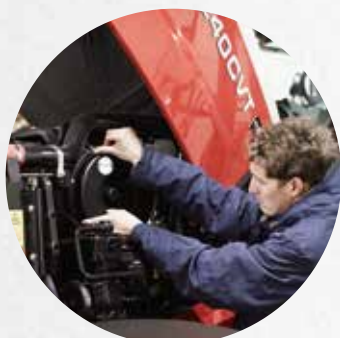
La limpieza continua mediante un filtro Piclon garantiza que solo sea necesario realizar el mantenimiento del filtro cuando se encienda el piloto correspondiente.
