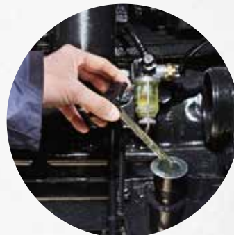
Comprobación del nivel de aceite y llenado sin subir el capó.
