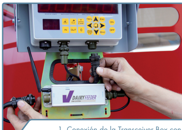
1. Conexión de la Transceiver Box con las células de pesada y la balanza de pesada
