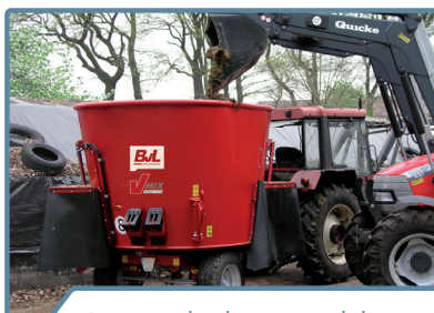
Puertas de descarga delantera a la derecha y trasera a la izquierda
