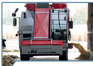
Cinta transportadora de descarga delantera con desplazamiento lateral (opcional)
