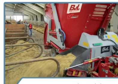
Cinta transportadora delantera combinada con cinta elevadora
