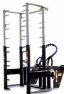
Horquilla mordedora para fardos de heno secos con agarres según fajo
