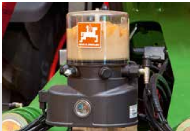
Bomba con depósito de reserva
