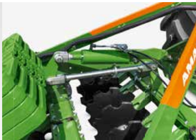
Ajuste hidráulico de la profundidad de trabajo
