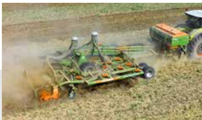
XTender 4200 con Cenius 6003-2TX y dos unidades de arrastre para esparcir abono y semillas
