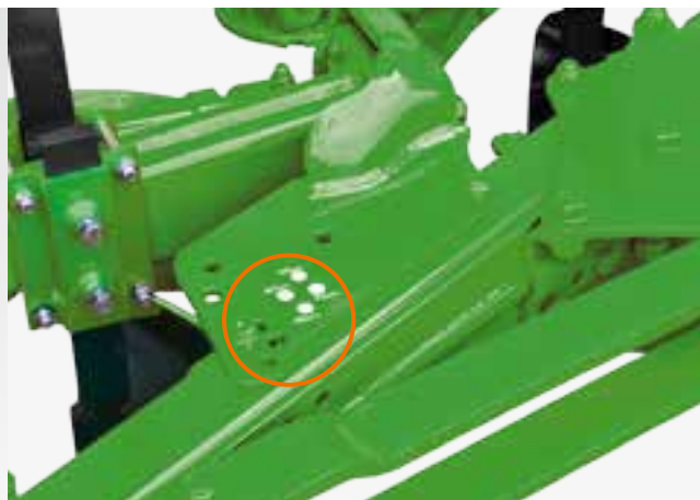
Ajuste mecánico del ancho de trabajo
