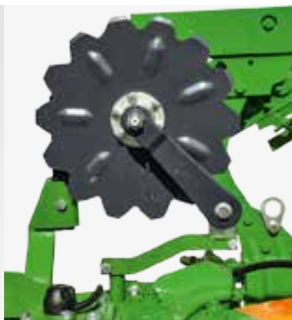
Cuchilla de disco con un diámetro de 500 mm
