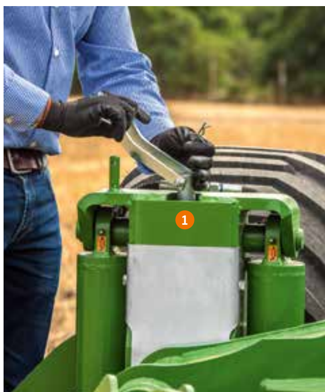
Ajuste de la profundidad de trabajo en la rueda del sistema semisuspendido
