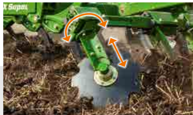
El elemento marginal: ajustable en altura e inclinación de forma independiente
