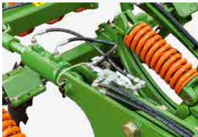
Cilindro para el ajuste de profundidad del panel de rejas
