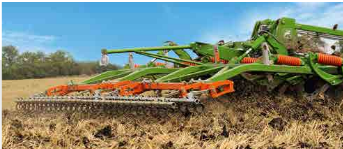
Rastra doble para el labrado superficial
