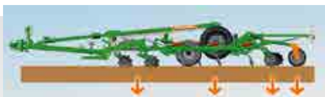
Ceus con todas las herramientas en posición de trabajo
