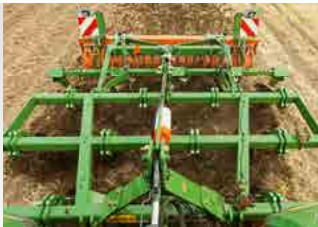
Estructura de bastidor de 3 hileras del Cenius 3003 Special
