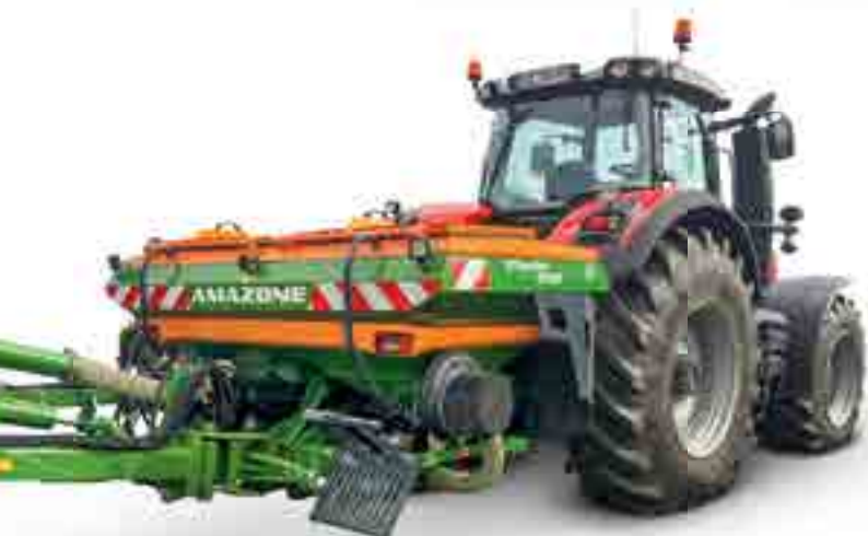
Contenedor suspendido XTender 2200 con una capacidad del depósito de 2.200 l
