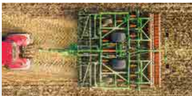
Detrás de la rueda hay una reja para la descompactación de la rodada
