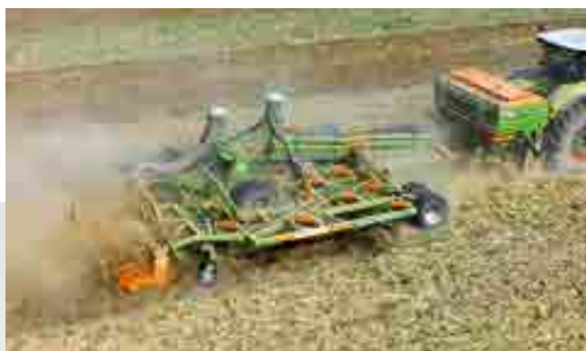
XTender 4200 con Ceniús 6003-2TX y dos unidades de arrastre para esparcir abono y semillas
