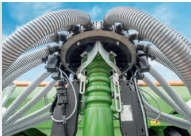
Cabezal distribuidor de segmentos con control eléctrico de mitades
