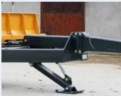
1814 - niveles de altura con ajuste hidráulico frontal delantero y trasero independiente
