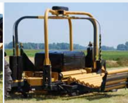
Proceso de encintado - superposición consistente de la película para cualquier tamaño de paca
