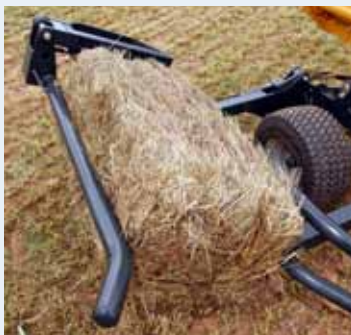
Brazo de agarre - garantiza una carga fiable y consistente de las pacas
