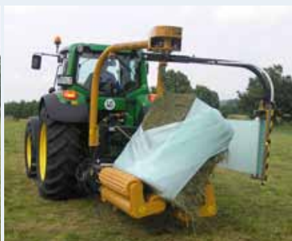
Sistema único de - Rock&Roll que gira la paca proporcionando una superposición consistente
