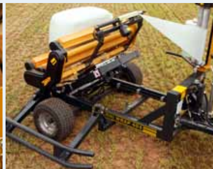
Sistema hidráulico de corte y puesta en marcha y descarga por inclinación
