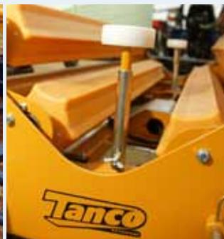
El sistema de rock&roll y parada de pacas garantiza un encintado controlado
