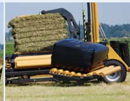
Cinta transportadora giratoria opcional - Permite una descarga suave durante la conducción
