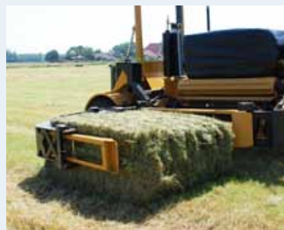
Brazo de carga de agarre pivotante único
