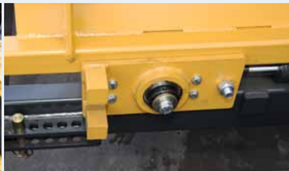
Rodillos con ajuste hidráulico para el cambio rápido del tamaño de las pacas
