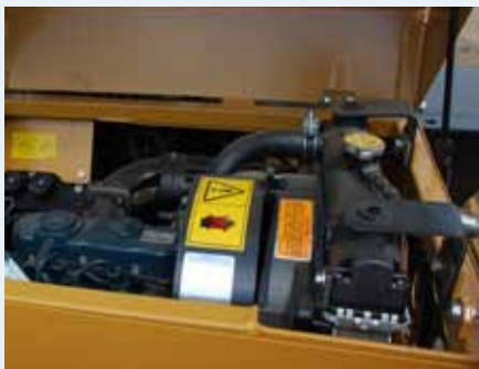
El motor Kubota de 3 cilindros y 20 c.v. permite el funcionamiento total de la encintadora estándar en 1814 S
