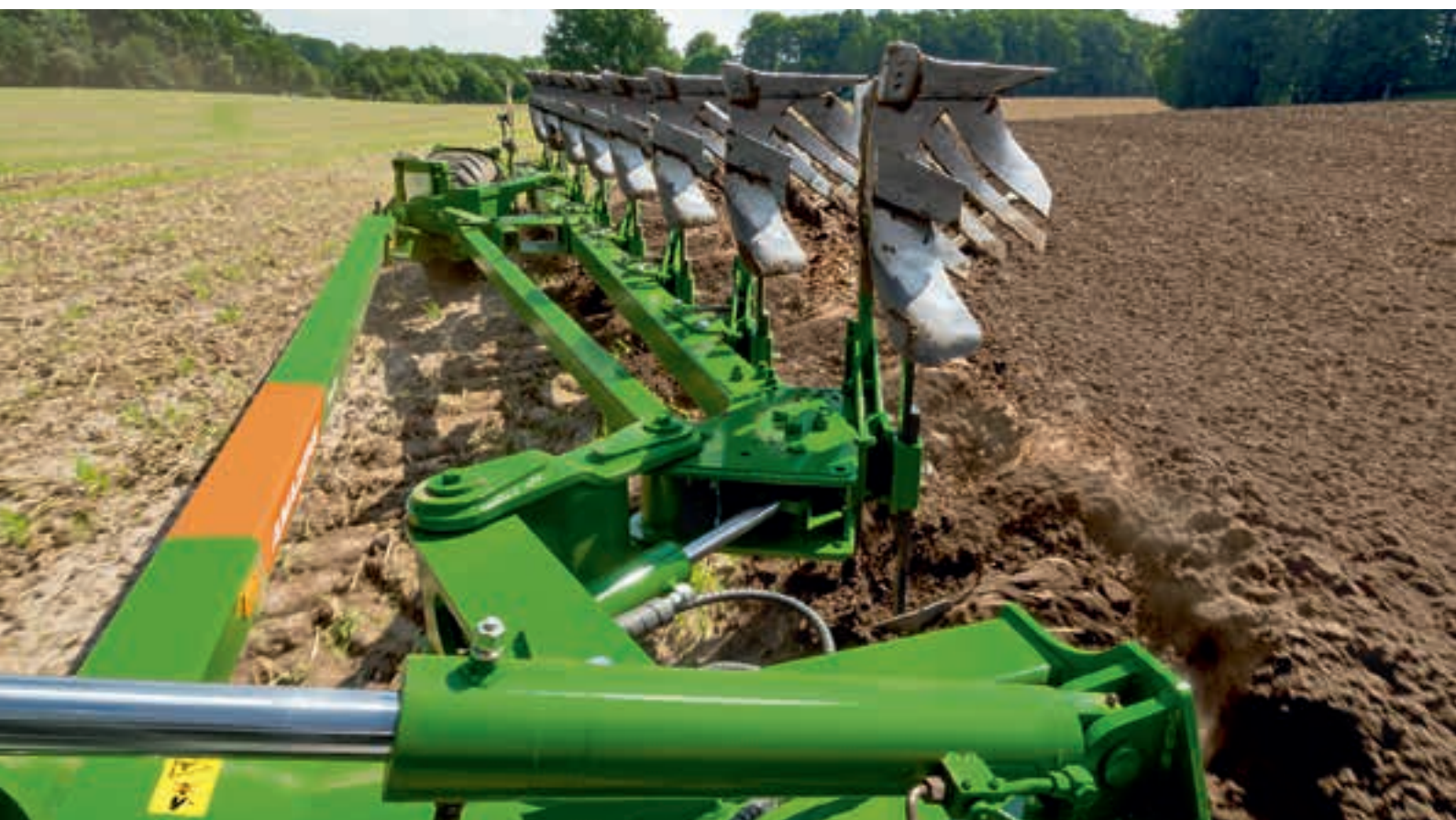
Hektor con protección contra piedras con fusible
