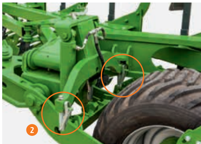
Ajuste del ángulo del arado
