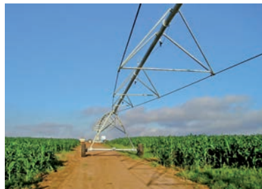
Puede remolcarse con rapidez girando sencillamente las ruedas de la torre motriz
