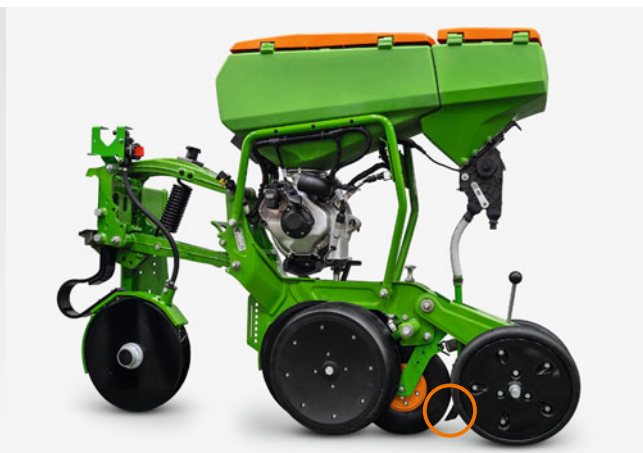
Esparcidora para microgranulado Micro con punto de salida en la hilera
