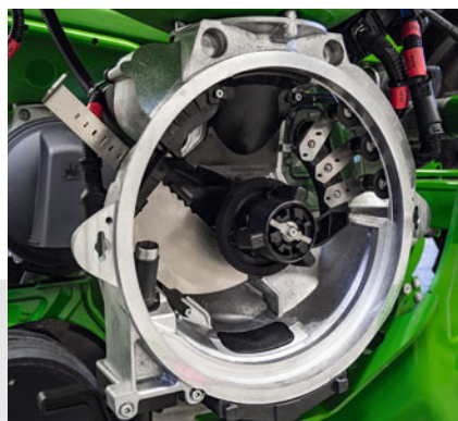
Vista de la dosificación sin disco de separación
