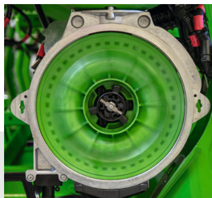
Disco de separación en funcionamiento (sin tapa)
