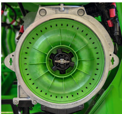
Disco de separación utilizado en estado parado
