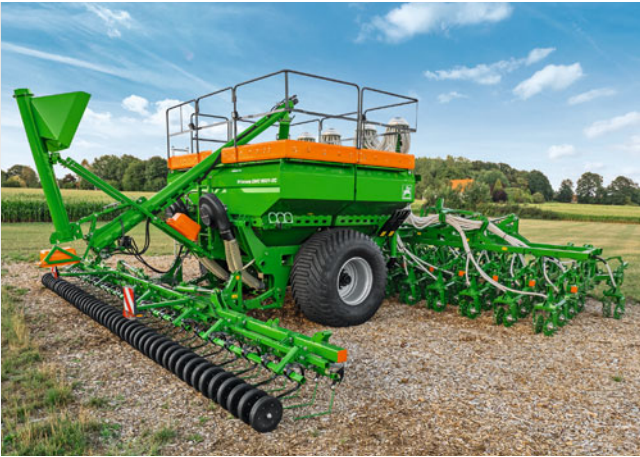
Primera DMC 9001-2C con tornillo sin fin de llenado
