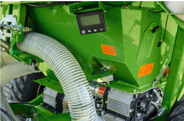
Primera DMC con dosificación eléctrica y TwinTerminal
