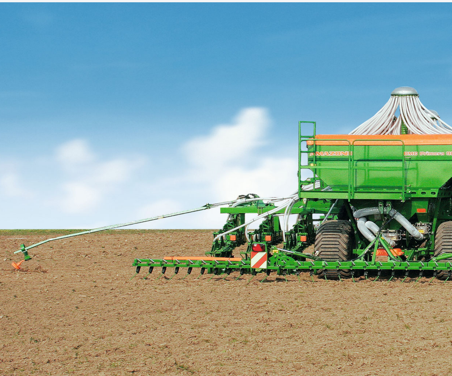
Primera DMC 9000-2C con ancho de trabajo de 9 m
