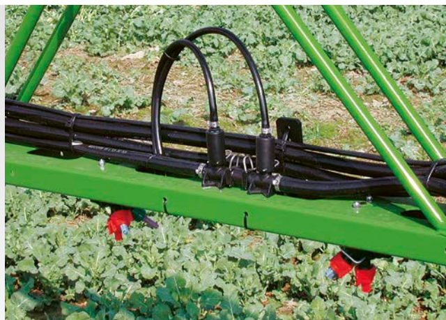
Sistema de circulación forzada (SCF)
