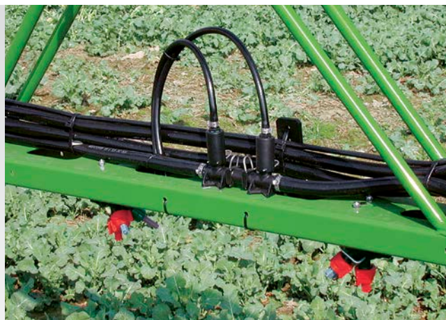
Sistema de circulación forzada (SCF)
