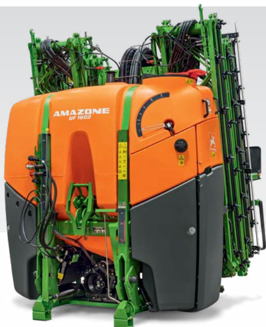
El UF 1602 con depósito de 1.600 l
