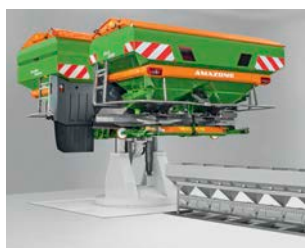
Nave de test de abonado
