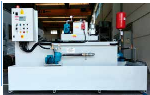
Sistema di filtrazione olio con rilancio automatico alle macchine utensili
