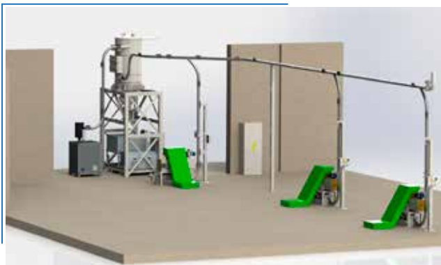
Esempio di impianto di trasporto pneumatico
