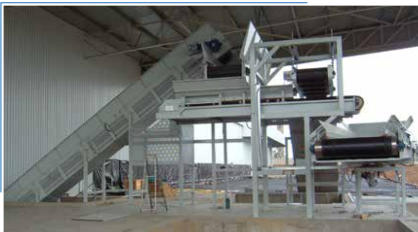
Impianto di trasporto e selezione di sfridi in alluminio e acciaio
