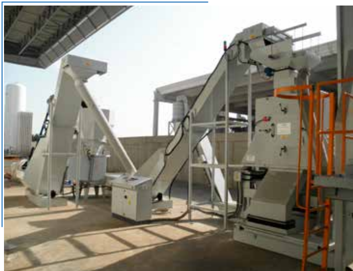
Impianto di triturazione e centrifugazione. Capacità: 3 Ton/h per trucioli di alluminio
