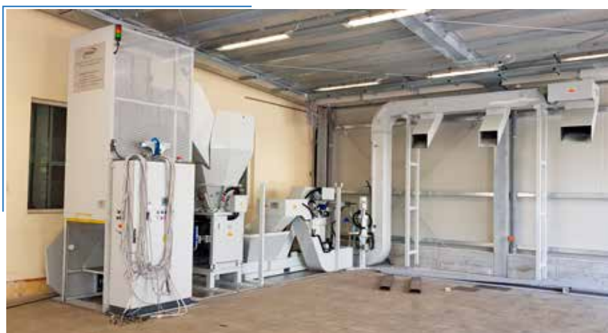
Minisystem® con elevatore ribaltatore, trituratore e scarico in container
