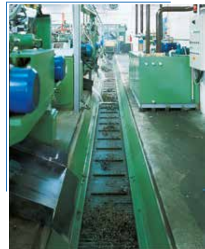
Linea per trasporto trucioli di acciaio ammatassati
