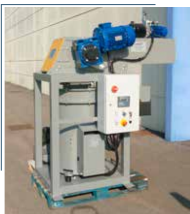
Unità compatta di triturazione e centrifugazione sotto macchina utensile
