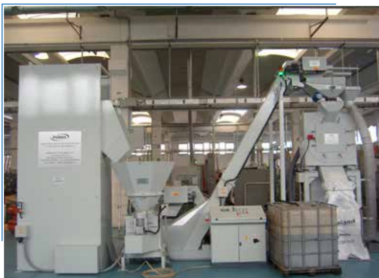
Sistema di centrifugazione dotato di elevatore ribaltatore e trituratore
