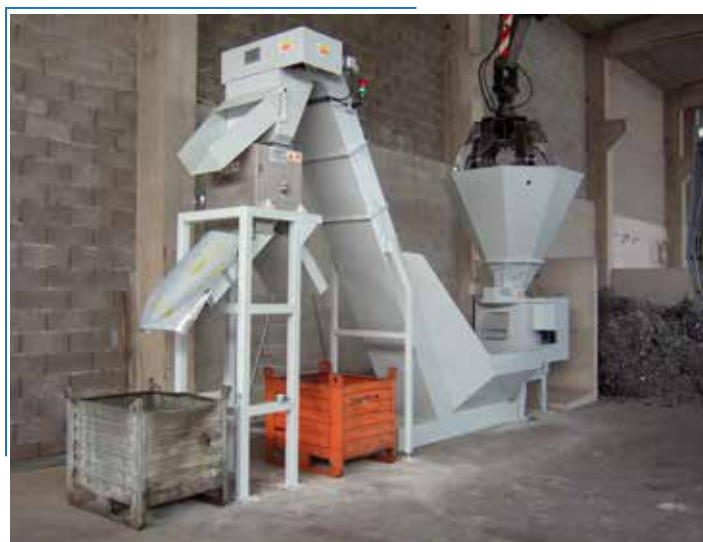
Impianto di triturazione e selezione trucioli magnetici e amagnetici
