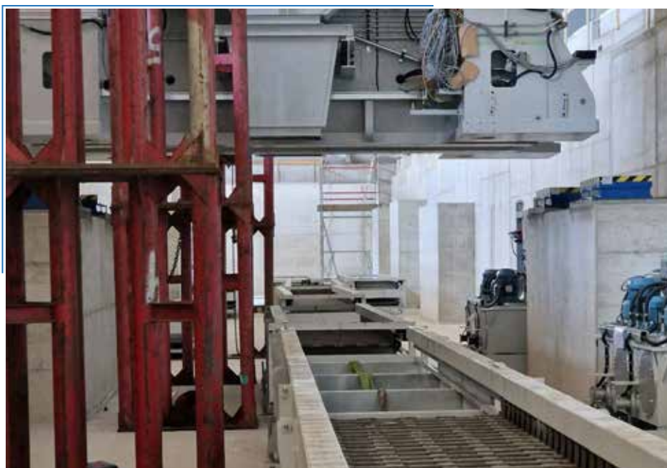
Sistema di trasporto sfridi posto sottostante una linea di presse
