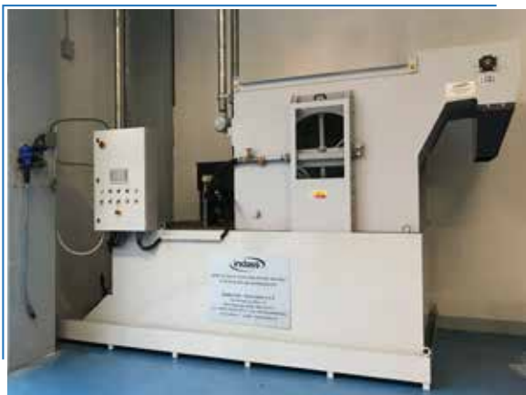
Sistema di filtrazione autopulente per olio ed emulsione con rilancio automatico alle macchine utensili
