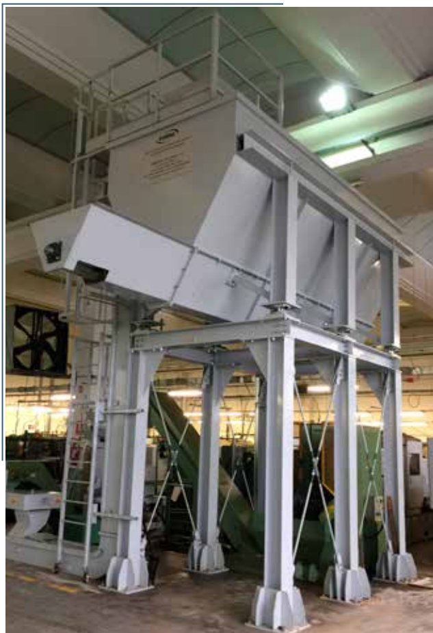
Silos orizzontale dotato di celle di carico
