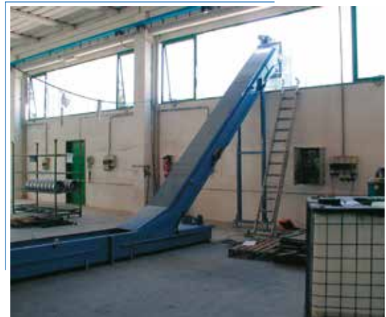
Linea per l'evacuazione dei trucioli di alluminio
