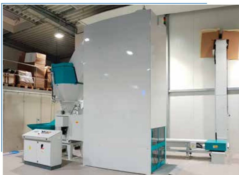
Impianto di triturazione, centrifugazione e containerizzazione
