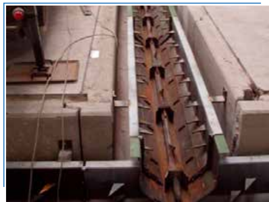
Linea di trasportatori ad arpioni per trucioli ammatassati
