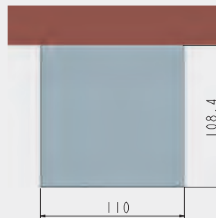
Instalación cofre directo a techo
