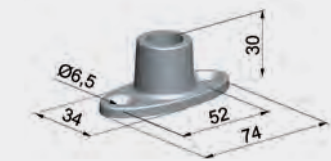
Montaje varilla - cable suelo
