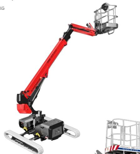
**Plataforma orugas autonivelante 16 m**
