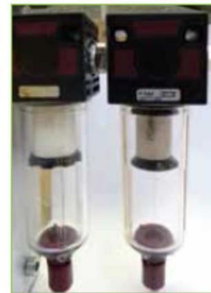
Filtros adicionales para ser colocados en la entrada de aire comprimido para la filtración adicional, también disponible con manómetro para comprobar y controlar la presión de la línea.
