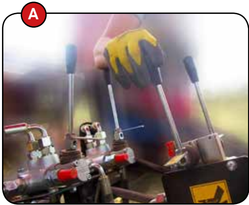
A. Accionamiento hidráulico.
