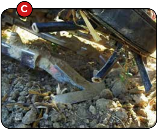
C. Vomere anteriore di raccolta Un vomere taglia il sistema radicante dell'aglio e poi lo solleva gentilmente per essere raccolto. La posizione e la profondità del vomere può essere regolata.
