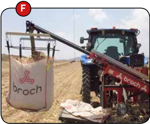
F. Cinta di confezionamento Una cinghia a ferri trasporta il bulbo al bins o al sacco, pulendolo nuovamente e facendo sì che si possa rimuovere parte dello scarto manualmente.
