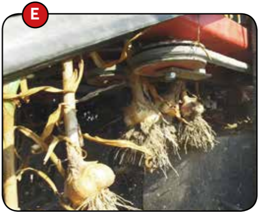
E. Disco di taglio Un secondo set di cinghie solleva i bulbi e un disco dentato con alti regimi di giro taglia le foglie ad un'altezza che può essere regolata, rimuovendo così parte della foglia e posizionando il bulbo sulla cinghia di confezionamento.
