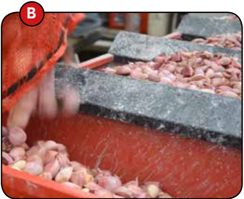
B. Unità indipendenti Ogni elemento seminante ha una propria tramoggia indipendente con una capacità di circa 50 kg, permettendo così la semina di diverse dimensioni di seme contemporaneamente. La distanza di semina tra le file è regolabile da 38 a 55 cm.
