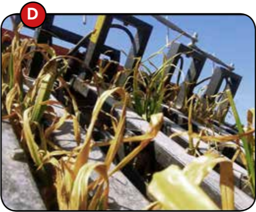
D. Nastro trasportatore e cinghie di pulizia Residui di terra sono tolti usando un sistema di vibrazione idraulico lungo il nastro trasportatore, mantenendo intatte le foglie.
