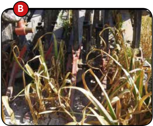
B. Guida di allineamento foglie Due guide anteriori sollevano le foglie cadenti e allineano le piante di aglio, così da rendere più agevole la raccolta lungo le cinte del nastro.
