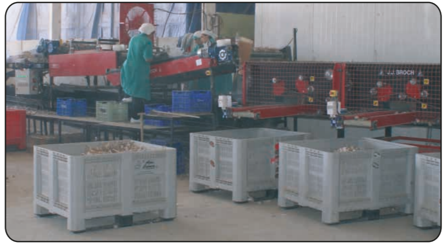
Calibratore per Aglio La grande dimensione della macchina migliora la redditività delle colture. La calibratrice modulare JJ Broch può essere adattata a tutte le misure necessarie per ottimizzare la commercializzazione delle colture.
