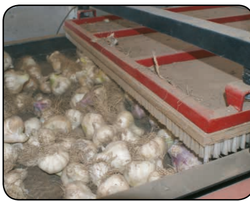
Spazzolatrice di aglio Elimina la terra, la buccia estrena e ogni altra parte usando una spazzola rotativa, senza danneggiare il prodotto.
