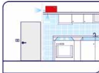
Instalación en un falso techo Installation in a suspended ceiling
