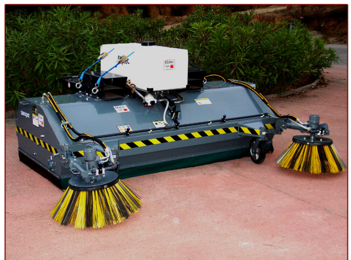
▲ Versión con doble sistema de cepillo lateral y sistema de riego - opción Model with two side sweeper system and sprinkler system - option
