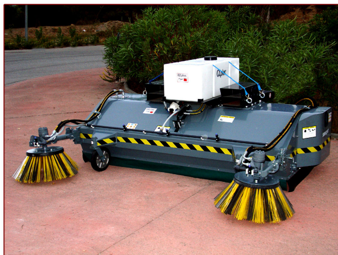
▲ Versión con doble sistema de cepillo lateral y sistema de riego - opción Model with two side sweeper system and sprinkler system - option
