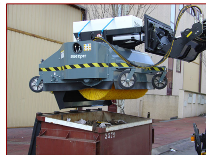
▲ Posible descarga en contenedor The dust can be emptied above a skip
