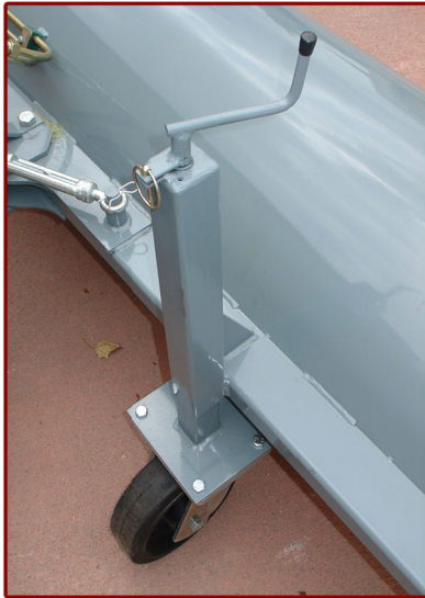
▲ Ruedas apoyo altura regulable Weels height adjustable
