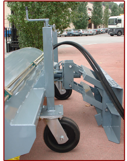
▲ Acoplamiento oscilante - Adaptación a las irregularidades del terreno Adaptation with oscillation - Adjustment to terrain irregularities
