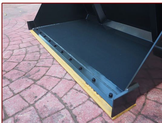
▲ Cuchilla atornillada doble uso más otra soldada Bolted blade of dual-use and other welded
