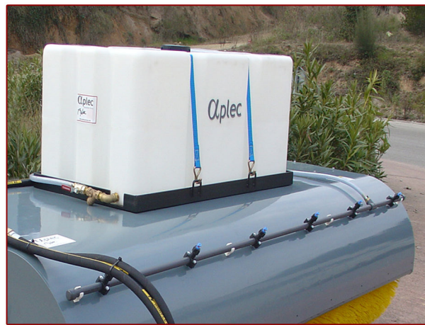
▲ Sistema de riego - opción Sprinkler system - option
