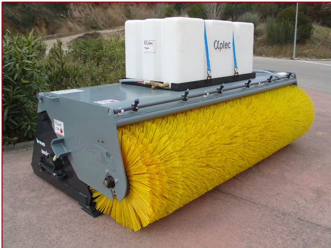
▲ Soporte apoyo eje cepillos para cambio de cepillos - opción Bracket support for the brush shaft for brushes change - option
