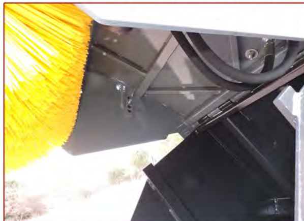
▲ Sistema regulación cepillo central en el interior. Adjusting system for the central brush inside.
