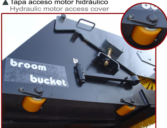
▲ Ruedas deslizamiento cuchara - opción Wheels for sliding the bucket - option
