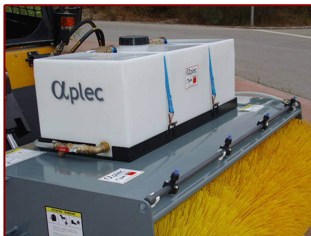
▲ Sistema de riego - opción Sprinkler system - option
