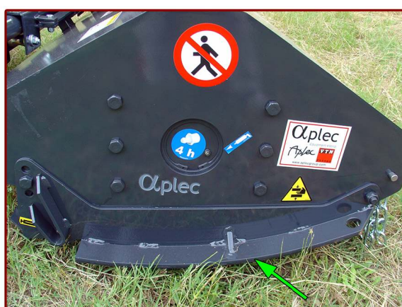
▲ Patines laterales de apoyo reemplazables Side skids with wearing undershoes
